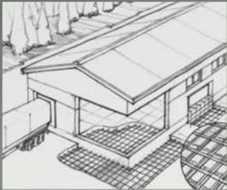
Förstärkning av fundament och golv
